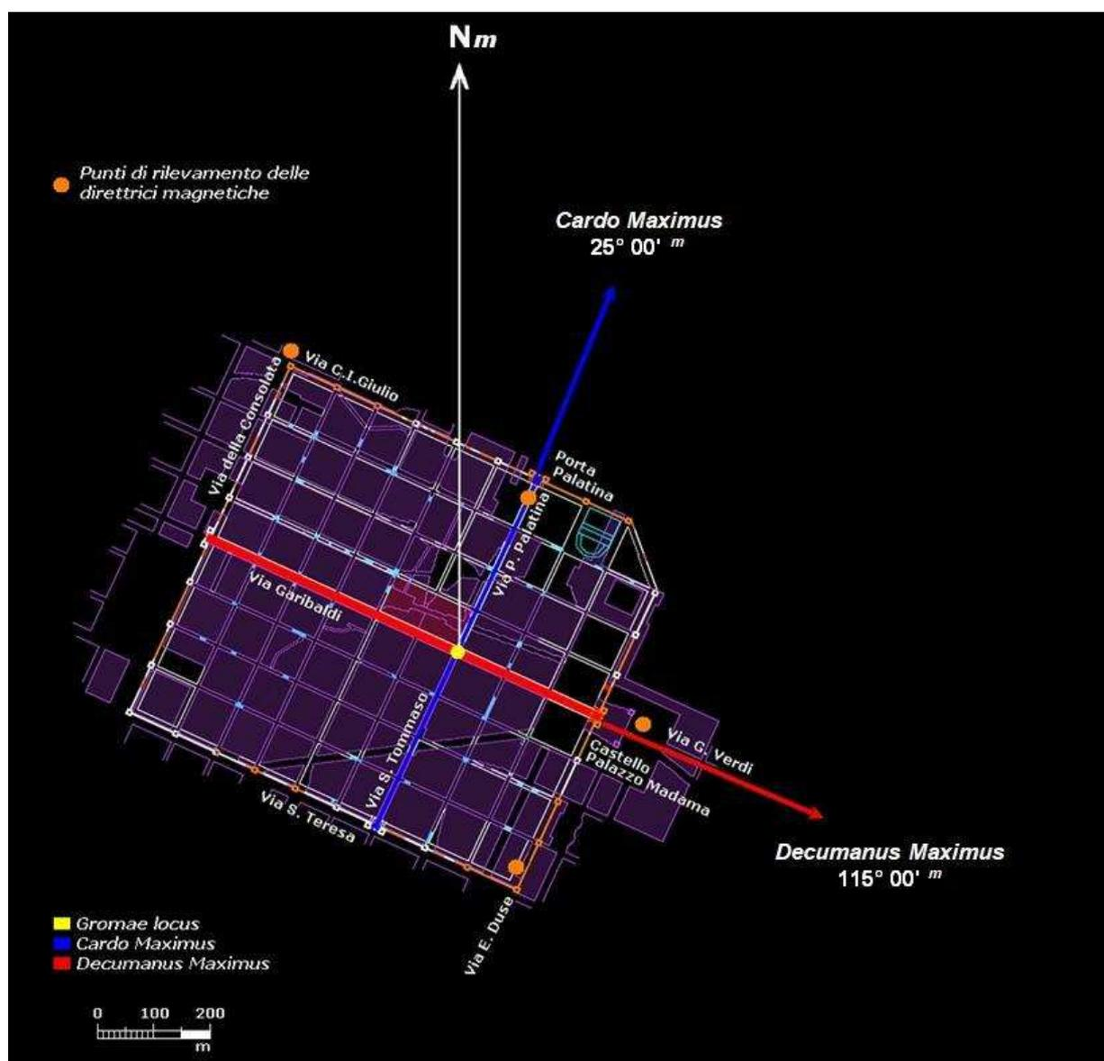
Figura 16: Azimut magnetici del "quadrilatero" con i punti di rilevamento.
