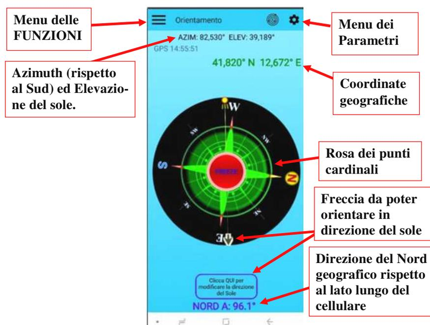
Figura 7. Il display del cellulare quando si usa la Funzione “Orientamento” con il metodo “Fixed”.
