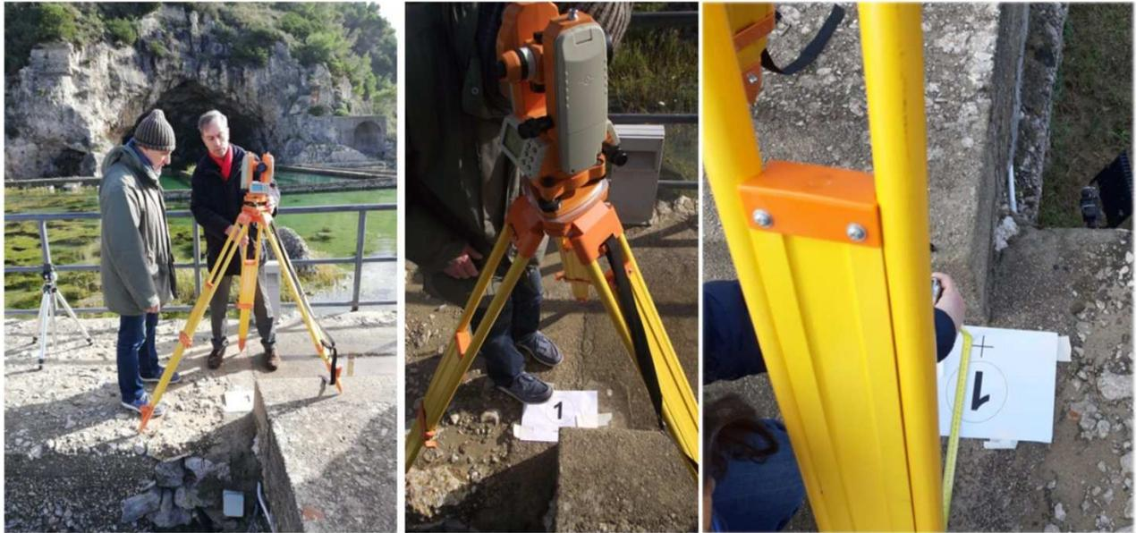
*Figura 3a: Foto della Postazione n. 1 durante il rilievo solare verso la Postazione n. 2: il “piombo ottico” del teodolite garantisce l’allineamento verticale tra l’asse del teodolite ed il centro della crocetta sul foglio di carta che funge da punto di riferimento della Postazione stessa.*
