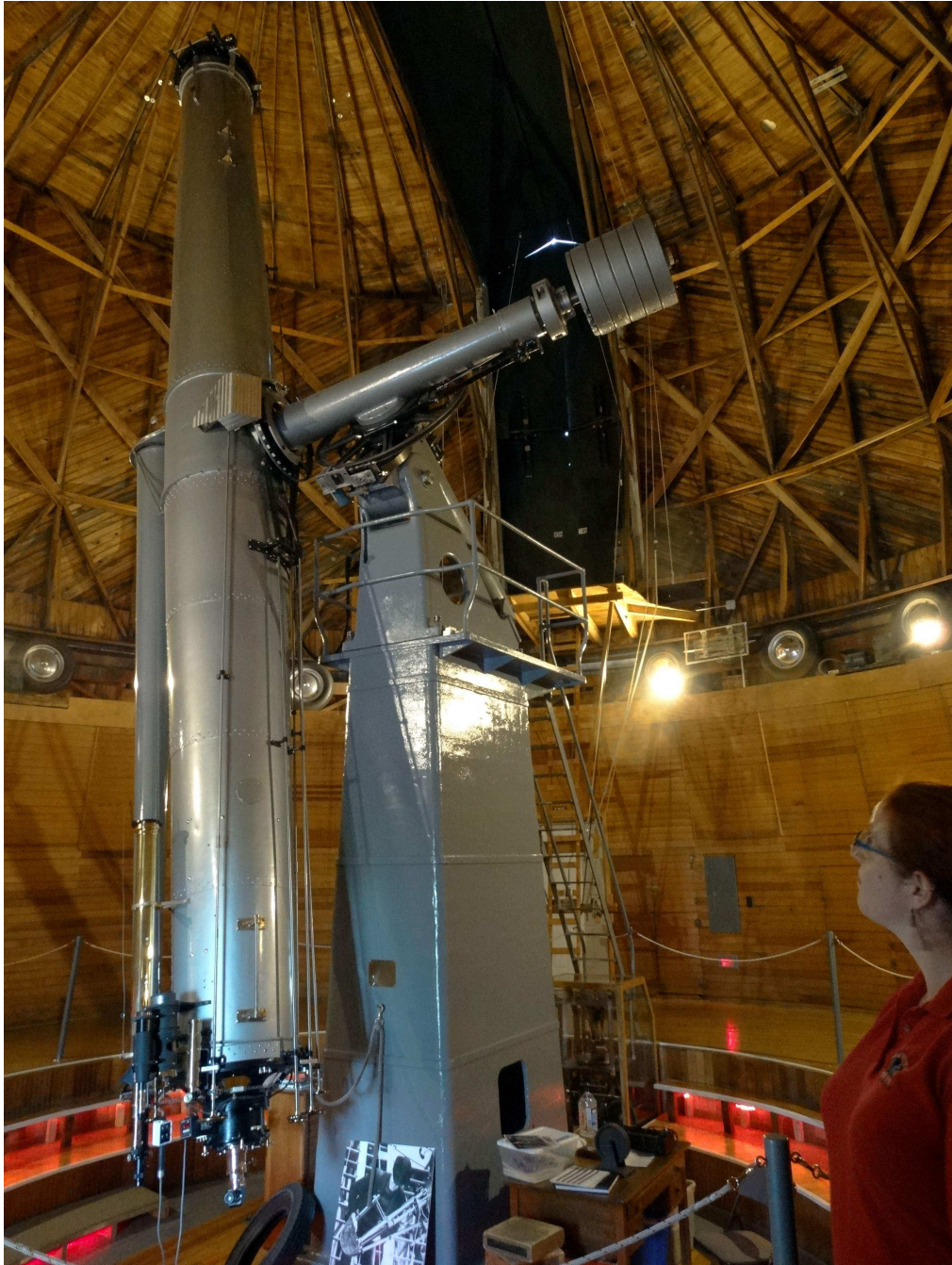
Foto n. 10. Lo storico rifrattore “Clark” da 61 cm (24”) dell’Osservatorio Lowell di Flagstaff, Arizona, USA, sistematicamente usato dal fondatore Percival Lowell (foto di W. Ferreri).
